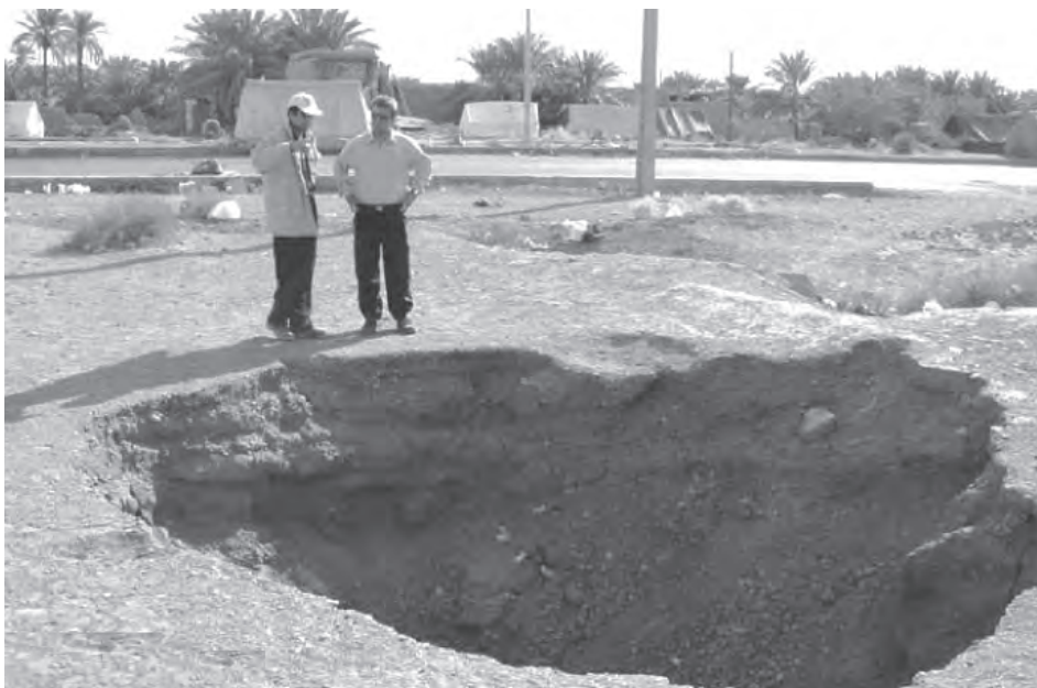
تصویر ۶-۳- ایجاد گود در اثر ریزش قنات در زلزله ۱۳۸۲ شهرستان بم (منبع: مرجع شماره ۱۴)
