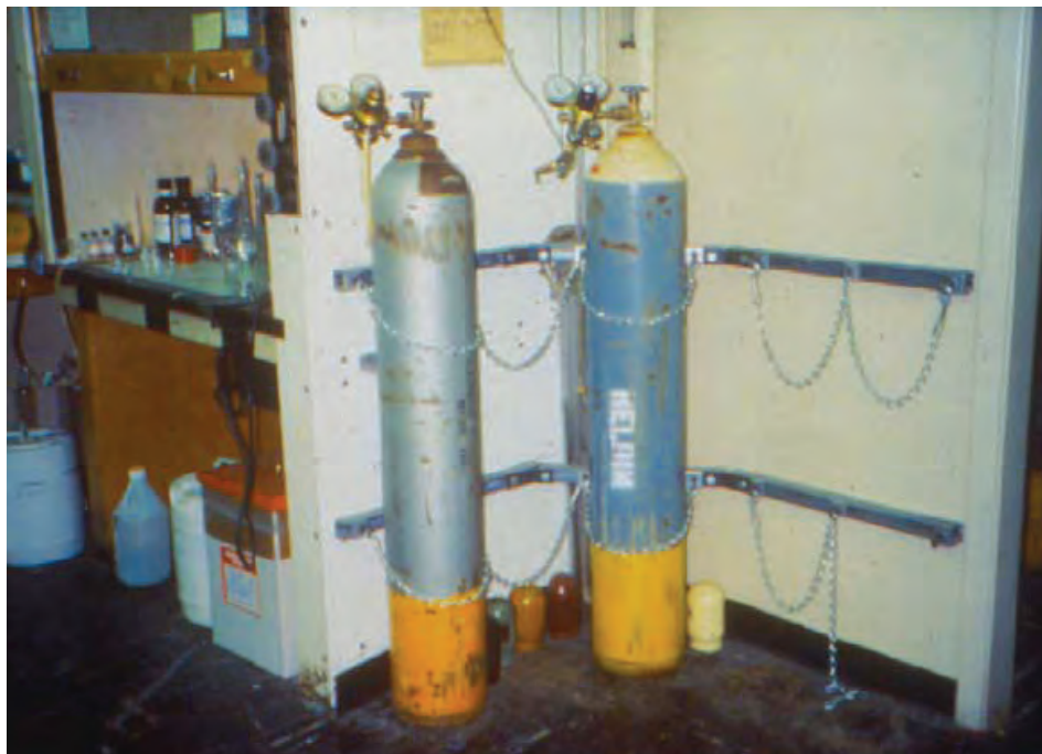
تصویر ۹-۱۱- مهار کردن کپسول‌های گاز و یا اکسیژن با استفاده از زنجیر
