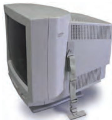
تصویر ۹-۷- نمونه‌ای از ایمن‌سازی رایانه و تجهیزات جانبی آن در برابر زلزله
